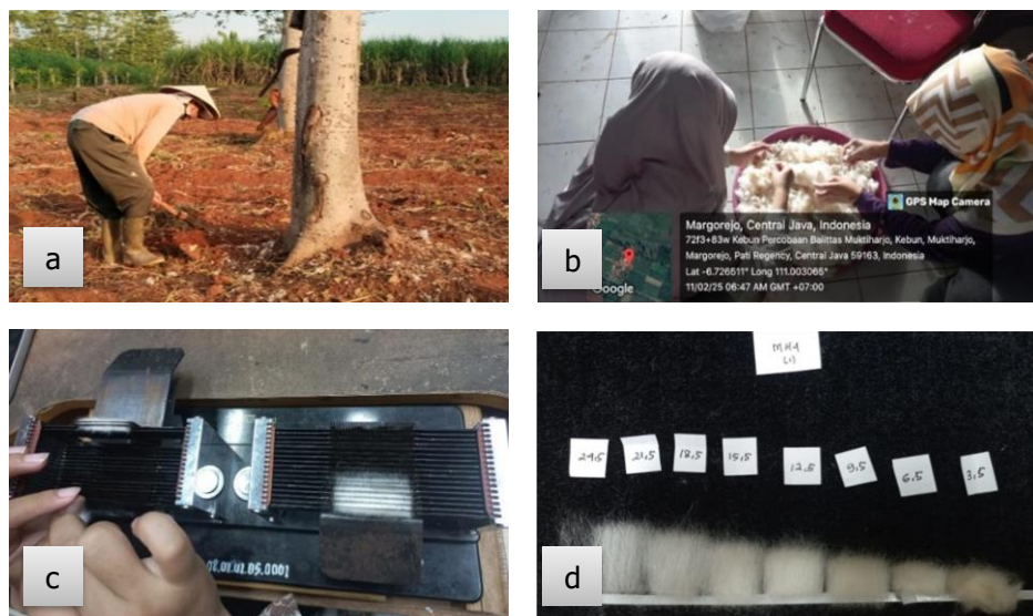
Gambar 17. Pemeliharaan Palsma Nutfah (a); Pengambilan Sampel Kapuk (b); Uji Combsorter (c); dan Sampel Serat berdasarkan Panjang Seratnya (d)
