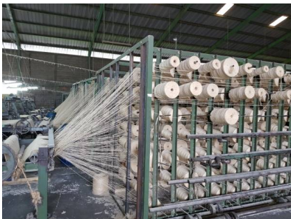
Benang serat agave ditenun menggunakan mesin tenun untuk produksi kain yang dimodifikasi.
