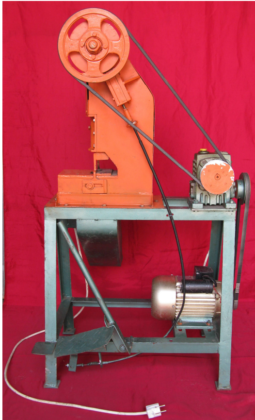
Gambar 7.1. Mesin Bud Chipper
