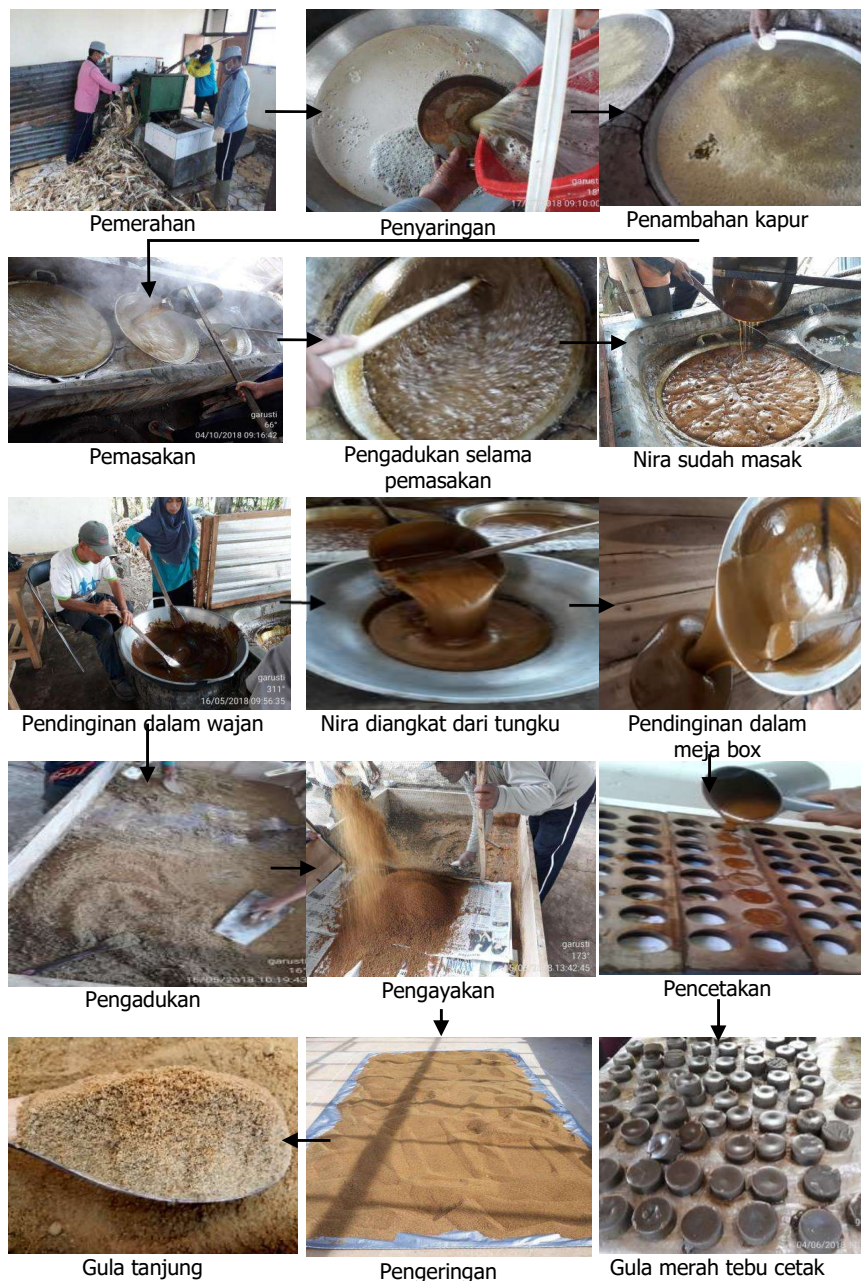
Gambar 33. Alur Proses Pengolahan Gula Merah Tebu Cetak dan Gula Tanjung
